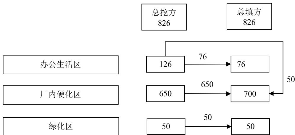
图 1.4-1 土石方流向图 单位:  $m^3$
